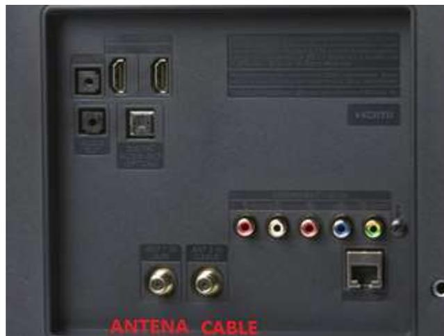
Los nuevos televisores comparten esta entrada y solamente hay que configurarlos mediante el control remoto no teniendo que hacer ningún cambio en la instalación del cable. Esta entrada se la llama Cable/Antena, especificando que sirve para los dos sistemas.
